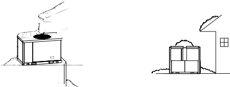
(d) Air inlet blocked by snow
