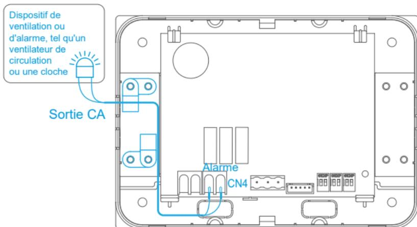
Méthode de câblage 2 : Faites passer le câble à travers le trou de la base de l'alarme de fuite de réfrigérant jusqu'aux bornes de CN4, et fixez le câble à la base avec un serre-câble pour éviter toute contrainte sur les bornes. Connectez l'autre extrémité du câble à l'extrémité d'entrée d'alimentation d'un dispositif de ventilation ou d'alarme.
