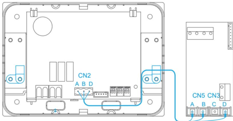
Méthode de câblage 2 : Faites passer le câble de communication à travers le trou de la base de l'alarme de fuite de réfrigérant jusqu'aux bornes A et B du CN5 et à la borne D du CN3 sur la carte d'extension de l'IDU.
