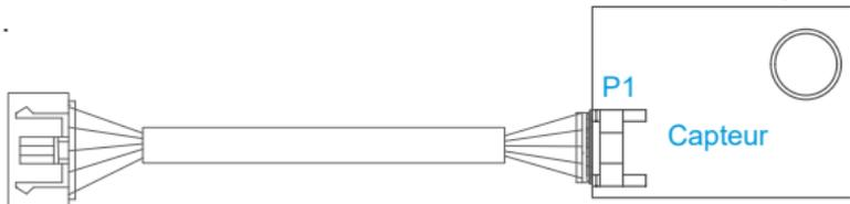
Étape 2 : Installez le capteur dans la fente du couvercle supérieur, le détecteur du capteur étant aligné avec l'entrée d'air du couvercle. Connectez l'autre extrémité du câble de connexion au CN6 sur la carte de commande du capteur et fermez la couverture.
