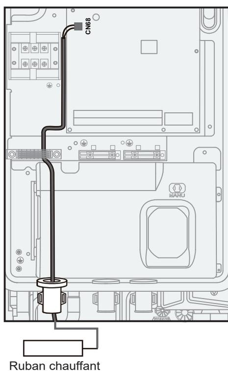
La puissance du ruban chauffant pour tuyau de drainage ne doit pas dépasser 40 W. Le courant de travail peut atteindre 200 mA, la tension d'alimentation est de 230 VCA.
