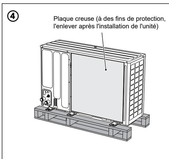
Pour la boîte d'accessoires, voir 2.4.1 Accessoires fournis avec l'appareil pour plus de détails.
