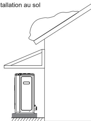
En cas de risque de glissement de neige depuis le toit, une protection ou une couverture doit être mise en place pour protéger la pompe à chaleur, les tuyaux et le câblage.
