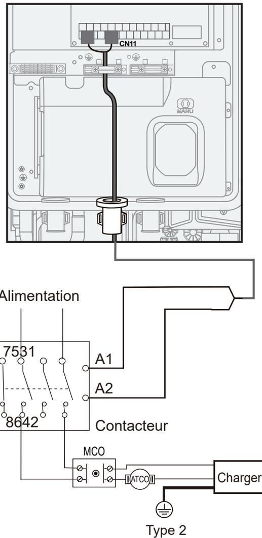
Port du signal de commande du module hydraulique : Le CN11 comporte des bornes pour la vanne à 3 voies, la pompe, le chauffage d'appoint, le réchauffeur, etc.
