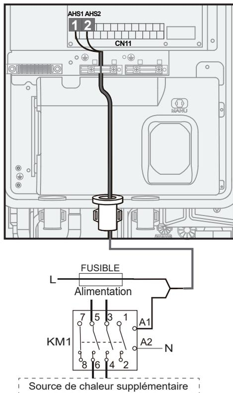
Le câblage entre le boîtier électrique et la plaque arrière est illustré au point 7.5.2 Câblage de l'alimentation principale.
