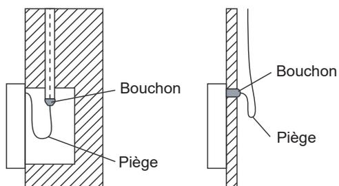
Pour éviter que l'eau pénètre dans la télécommande filaire, utilisez un piège et du mastic pour sceller les connecteurs des fils lors du câblage.
