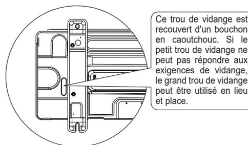
Ce trou de vidange est recouvert d'un bouchon en caoutchouc. Si le petit trou de vidange ne peut pas répondre aux exigences de vidange, le grand trou de vidange peut être utilisé en lieu et place.
