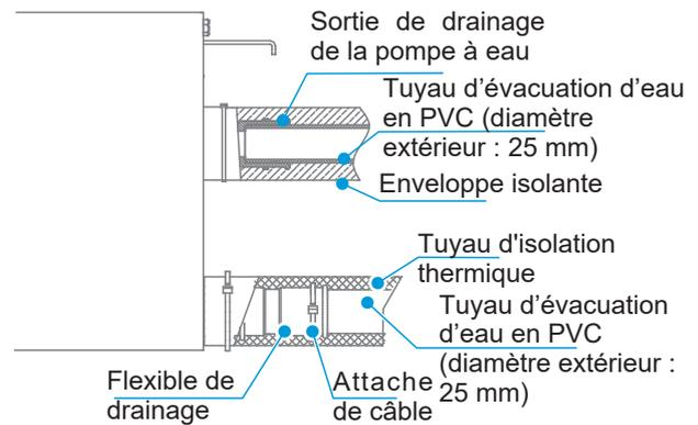
② Le tuyau de raccordement de la pompe à eau et le tuyau de drainage (dans la partie intérieure) doivent être enveloppés uniformément avec un tuyau d'isolation thermique et liés avec des attaches de câble pour empêcher l'entrée d'air et la production du condensat.
