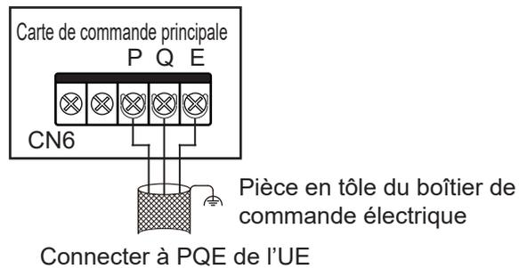
Système : La longueur totale maximale du câble de communication P/Q/E de l'UI et de l'UE peut atteindre 1 200 m et peut être connectée en série, comme indiqué dans la figure ci-dessous :
