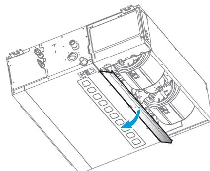
**3** Appuyez sur la boucle du boîtier supérieur de l'hélice et faites pivoter le boîtier inférieur de l'hélice autour du bord avant du boîtier inférieur de l'hélice d'environ 30 degrés.
