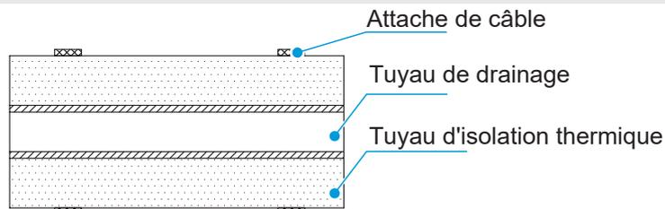
③ Pour éviter que l'eau ne reflue dans le climatiseur lorsqu'il s'arrête de fonctionner, le tuyau de drainage doit être incliné vers le bas vers l'extérieur (côté vidange), avec une pente descendante de 1/100 ou plus. Le tuyau de drainage doit être positionné dans la même direction que la sortie de drainage du corps de l'unité dans la direction gauche et droite, de sorte que le tuyau de drainage ne se dilate pas et ne recueille pas l'eau ; sinon, cela peut provoquer un bruit anormal.
