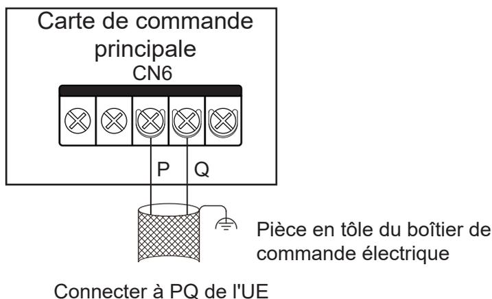
Système : La longueur totale maximale du câble de communication P/Q de l'UI et de l'UE peut atteindre 1 200 m et peut être connectée en série, comme indiqué dans la figure ci-dessous :
