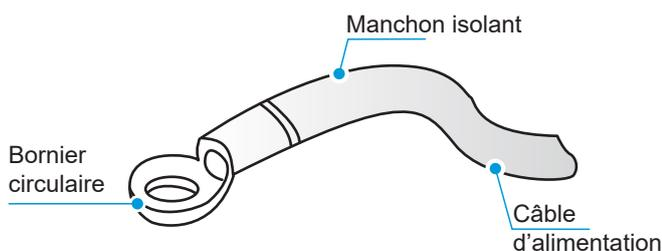
**C** S'il n'est pas possible de sertir le bornier circulaire isolé en raison de limitations sur site, connectez les câbles d'alimentation de même diamètre aux deux côtés du bornier d'alimentation de l'UI, comme indiqué dans la figure ci-dessous.
