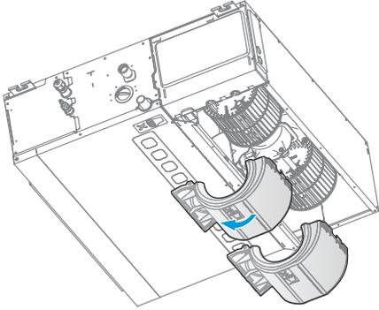
**4** Desserrez les vis de fixation de la plaque d'étanchéité du moteur et de la roue éolienne.
