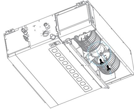
**5** Retirez le moteur et la roue éolienne ensemble.
