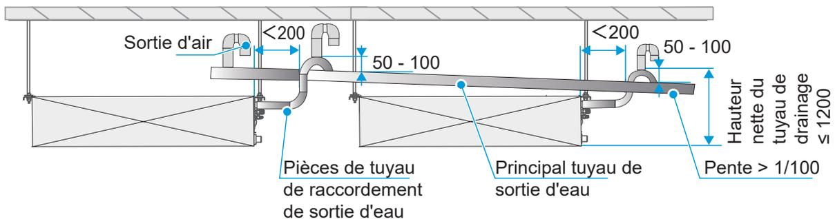
Les tuyaux de drainage des pompes de vidange de plusieurs unités sont connectés au tuyau de drainage principal pour être évacués par le tuyau d'égout.
