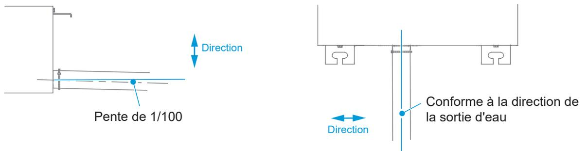
④ Lors du raccordement du tuyau de drainage, ne tirez pas sur le tuyau de drainage avec force, sinon il pourrait se desserrer. La longueur latérale du tuyau de drainage doit être inférieure à 20 m et un point d'appui doit être défini tous les 0,8 à 1,0 m pour éviter la résistance de l'air causée par la déformation du tuyau de drainage. Le tuyau de drainage doit être équipé d'un point d'appui tous les 1,5 à 2,0 m.
