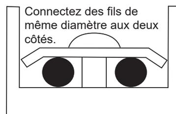
**D** N'appuyez pas sur les câbles d'alimentation de même diamètre de fil au même côté de la borne. N'utilisez pas deux câbles d'alimentation de diamètres de fil différents pour les mêmes borniers ; sinon, ils peuvent facilement se desserrer en raison d'une pression inégale et provoquer des accidents, comme indiqué dans la figure ci-dessous.
