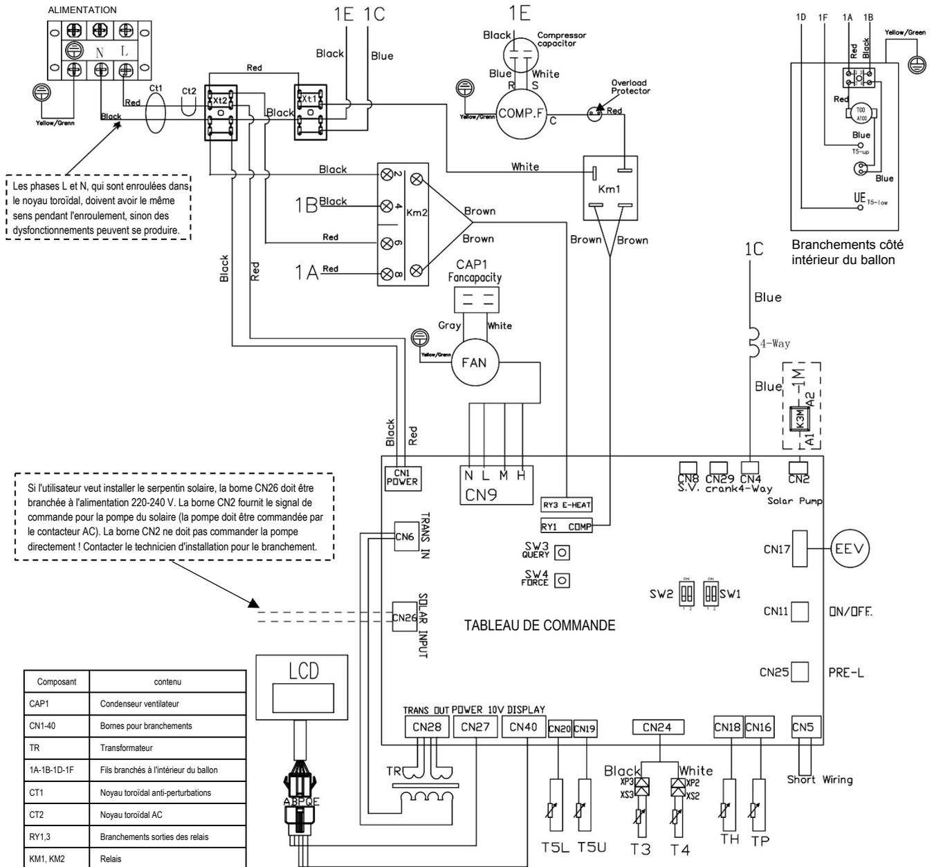
Si l'utilisateur veut installer le serpentin solaire, la borne CN26 doit être branchée à l'alimentation 220-240 V. La borne CN2 fournit le signal de commande pour la pompe du solaire (la pompe doit être commandée par le contacteur AC). La borne CN2 ne doit pas commander la pompe directement ! Contacter le technicien d'installation pour le branchement.
