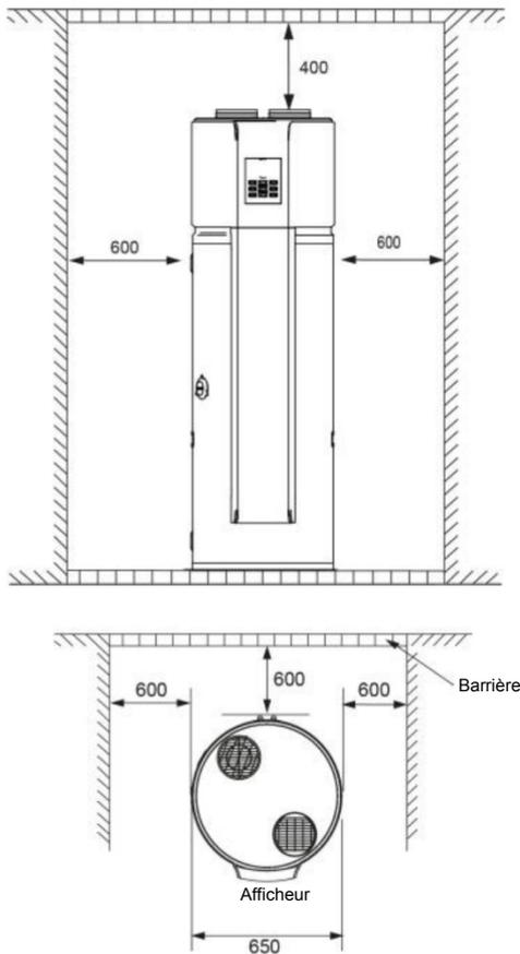
Installer l'unité en intérieur ; il est interdit d'installer l'unité dans des espaces non protégés de la pluie.
