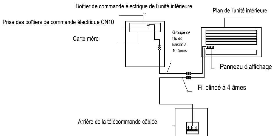
3) Le câblage du contrôleur câblé se connecte à l'unité intérieure de type conduit à pression statique élevée.
