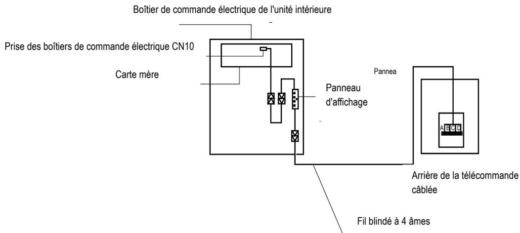
4) Le câblage du contrôleur câblé se connecte à l'unité intérieure de type suspension au mur.
