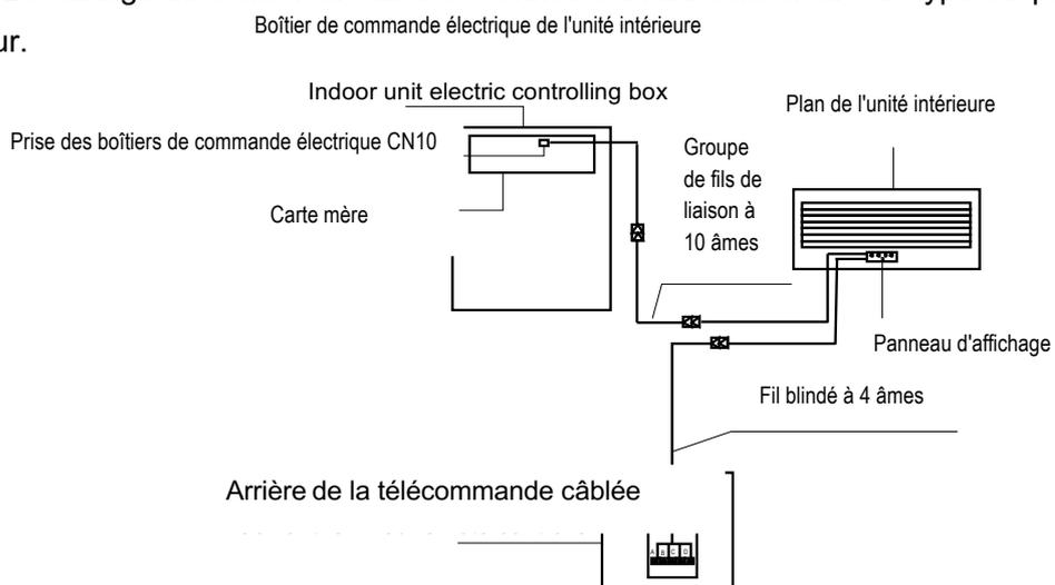
5) Le câblage du contrôleur câblé se connecte à l'unité intérieure de type suspension au support.
